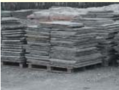
Lose da tetto
