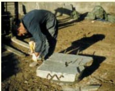
Separazione di una lastra con spacco a mano e attrezzi tradizionali per spacco a mano
