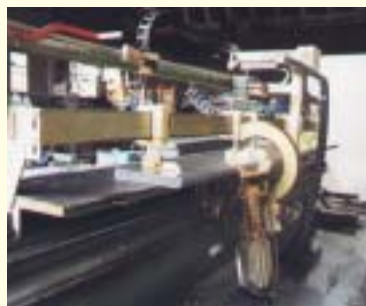
Macchinario per levigatura e lucidatura; e operazioni di fiammatura a mano
