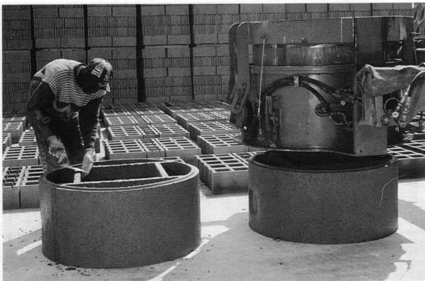
Un operaio rifinisce una tubazione per fossa biologica.
