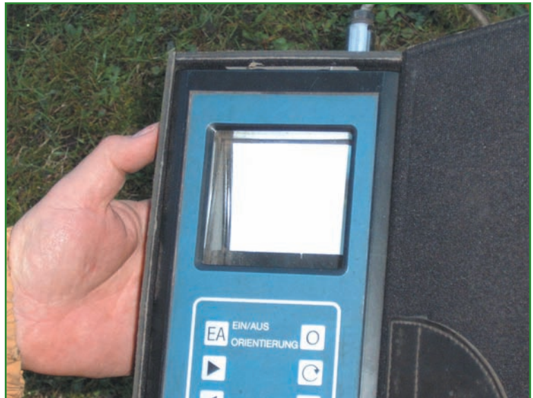
Il monitor della videoispezione: qui si vedono nel dettaglio le condizioni della propria canna fumaria. Spazzacamino? Sì, ma tecnologico
