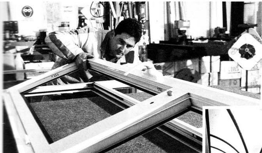
Sopra: Il montaggio di una porta.
