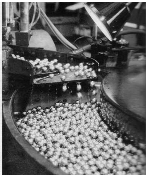
Particolare all'uscita delle sfere dalla «lappatura».
