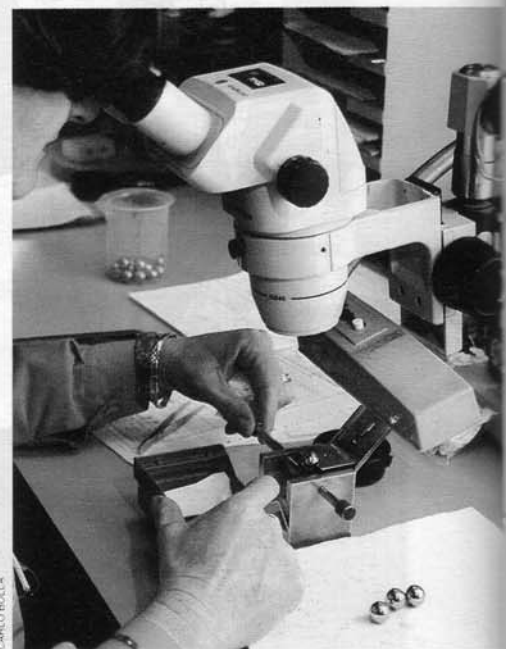
Una fase del controllo al microscopio delle sfere.
