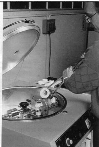
Al termine della fusione il metallo è stato iniettato nella forma.
